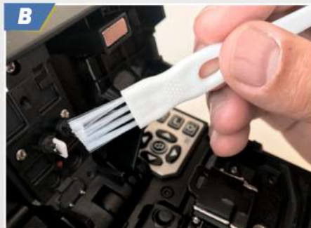
Limpeza das travas dos V-grooves
