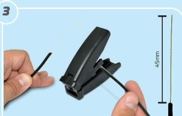
Decape o cabo óptico compacto em 45mm. Remova **apenas** a capa externa. Utilize a ferramenta: **Decapadora de cabos ópticos compactos**.
