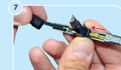
Insira a fibra óptica até o final do Conector Óptico SC-APC. Obs.: É necessário que a trava de segurança esteja posicionada p/ trás (imagem acima).
