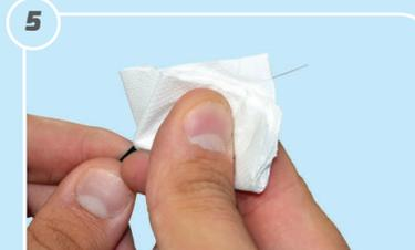
Limpe **todas as impurezas encontradas na fibra**. Obs.: Para uma boa conectorização é fundamental que esse passo seja feito com 100% de atenção.
