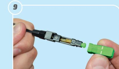
Insira a capa do conector para concluir o processo de montagem do Conector Óptico SC-APC.
