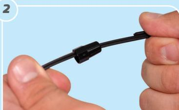
Passa a **Rosca de Travamento** no cabo óptico compacto antes de realizar todo o processo de conectorização.
