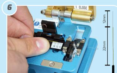
Clive a fibra óptica na medida exata (12mm) para realizar uma boa conectorização. Utilize a ferramenta: **Clivador Óptico**.
