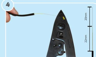
Remova **totalmente** a película em acrilato que reveste a fibra óptica (20mm). Utilize a ferramenta: **Alicate decapador de fibras ópticas**.
