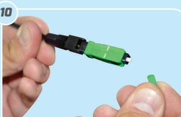
Antes de utilizar o Conector Óptico SC-APC **remova a capa protetora do ferrinho**. Obs.: Só retire a capa protetora quando for utilizar o conector.
