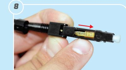
Após inserir a fibra óptica, **deslize a trava de segurança para a frente** (imagem acima). Isto impede que a fibra se solte do conector.
