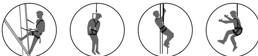
**Zona livre de queda:** A zona livre necessária depende do comprimento do subsistema mais o alongamento do sistema de absorção.
